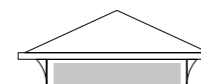
Insegna integrata nella fascia sottotetto con illuminazione interna, applicabile a ogni modulo
