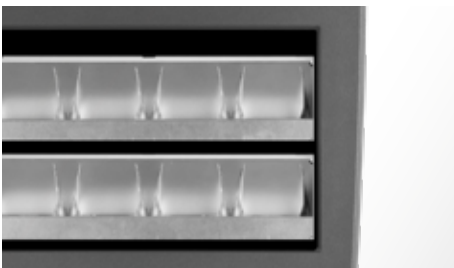
Riflettori ad altissime prestazioni in alluminio purissimo brillantato ed ossidato con successivo trattamento PVD silver 99,99%. Esso permette di avere una superficie con riflettanza superiore al 97% e priva di iridescenza
