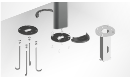
Per l'installazione è disponibile come accessorio una controflangia in acciaio inox per ancoraggio nel cemento
