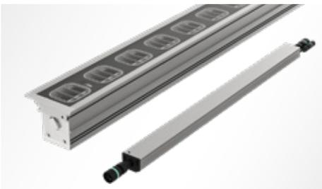
Alimentatore integrato, sostituibile e a tenuta stagna (IP 67) a tensione di rete (230-240V). Facilità di ispezione, riparazione, sostituzione e collegamento.
