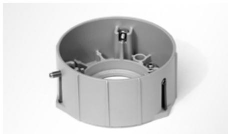
Basamento per il fissaggio a pavimento in alluminio pressofuso verniciato a polveri poliestere previo trattamento di conversione chimica superficiale.
