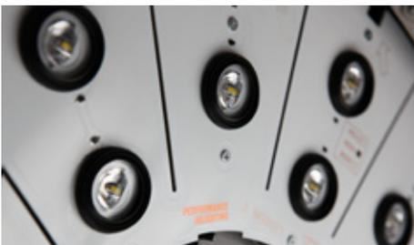
Ogni LED è accoppiato con un dispositivo elettronico di sicurezza (NUD) in grado di bypassarlo in caso di guasto
