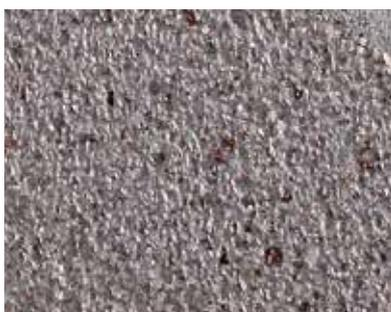
**SERIE BOCCIARDATA:** Sono cordonate che vengono prodotte in unico impasto di calcestruzzo, utilizzando materie prime selezionate, quali sabbie silicee, porfido e basalto. La cordonata viene successivamente sottoposta a un trattamento di rilavorazione chiamata bocciardatura dove viene rimossa la parte superficiale dell'impasto valorizzando i materiali naturali che compongono il manufatto.
