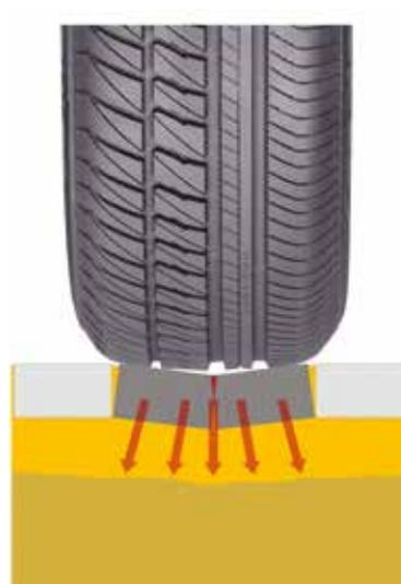
La realizzazione del letto di posa in maniera difforme a quella consigliata, può provocare un cedimento dello strato stesso. Tale cedimento comporta la rotazione dei masselli appoggiati al di sopra e la conseguente scheggiatura degli spigoli.
