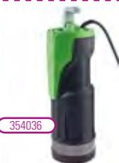
KIT di pompaggio ideale per utilizzare l'acqua piovana ad uso irriguo per serbatoi HERCULES. Composto da pompa sommergibile con pressostato e regolatore di flusso integrato con accensione e spegnimento automatico. Potenza 0,90 KW - Pressione max 3,6 Bar - Portata max 5600 l/h Profondità max immersione 8m.
